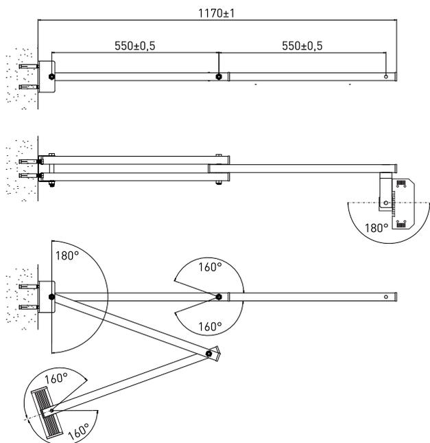
Кронштейн со светильником рекомендуется к применению для подсветки пространства кузова автомобиля или прицепа при погрузочно-разгрузочных работах.
